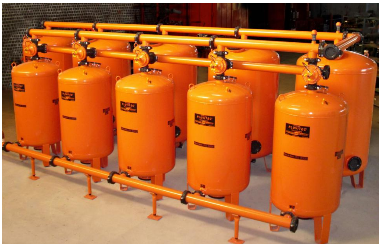
ETA compacta instalada em Igreja Nova/AL. Vazão: 30 m 3 /h (8,3 L/s)
